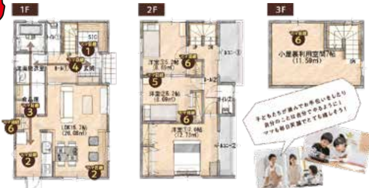
【参考施工例】2階建3LDK+小屋裏収納+カーブス 住宅面積/98.53㎡ (29.7坪) 1F:48.85㎡ 2F:49.68㎡
